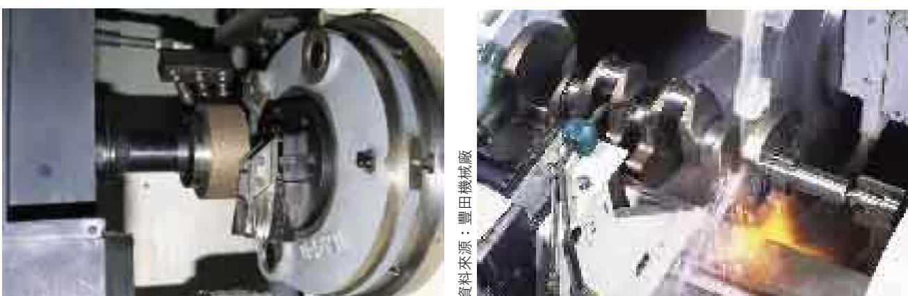
輪齒的成型磨削是Borazon 500的一項重要應用。這一過程提高了幾何精度和表面完整性，從而製造出更加堅固、更加安靜、更加耐久的元件。
